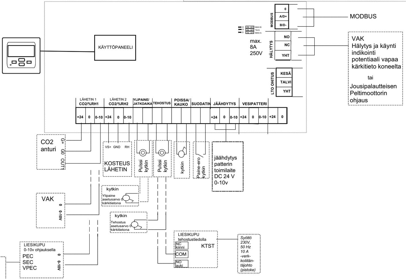
IV-koneen puhallinnopeutta voidaan ohjata Ultra PEC, SEC, VPEC, DS-600 EC, DSA-900 EC liesikuvilla tai 0-10v jänniteviestillä kaukovalvomosta. Jänniteviesti kytketään CO<sub>2</sub>/RH1 liittimeen Huoltovalikosta otetaan käyttöön lähetin 1 (ULK)
