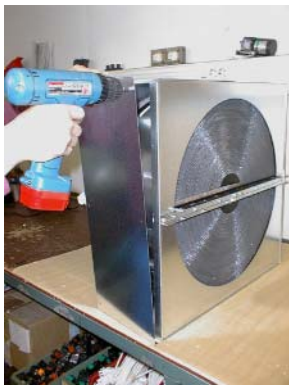
Kuva 1 Kannen avaaminen, 6 kpl ruuvia
