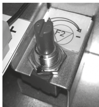
Kun mahdollinen säätö on saatu suoritettua, merkitse esim. tussilla potentiometriin viiva kuvan osoittamalla tavalla. Tällöin se on käännettävissä takaisin, jos se jostain syystä muuttuu.
