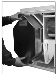
Jäätymisenestotermostaatti (F) Poista ensin lämmöntalteenottokenno, sitten termostaatin säätöruuvia suojaava tulppa.
