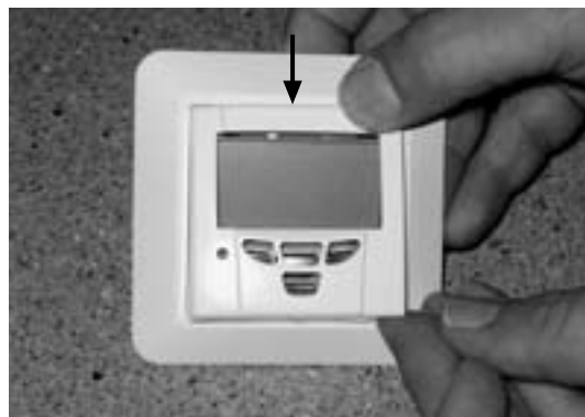
Infästning av panelens lock i ILTO Premium styrenhet. Sätt först lockets övre kant på plats och tryck sedan fast locket.
