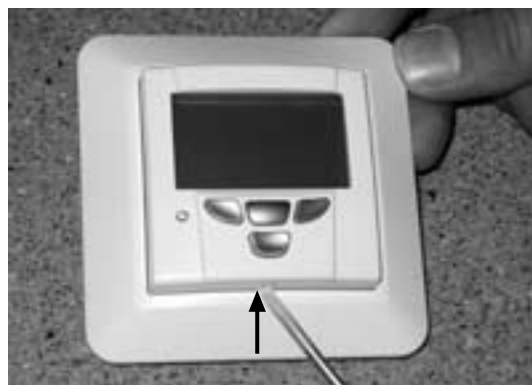
Borttagning av panel från ILTO Premium styrenhet.
