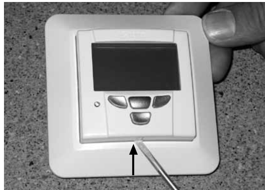
Paneelin irrottaminen ILTO Premium -säätimestä.
