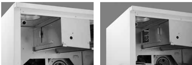
Lämmönvaihtimen ohitus: talvella luukku on kiinni, kesällä auki.
