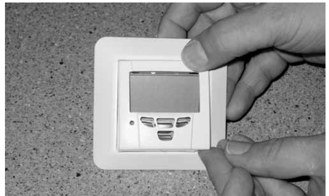
Paneelin kannen kiinnitys Premium-säätimeen. Aseta ensin kannen yläreuna paikalleen ja paina sitten kansi kiinni.
