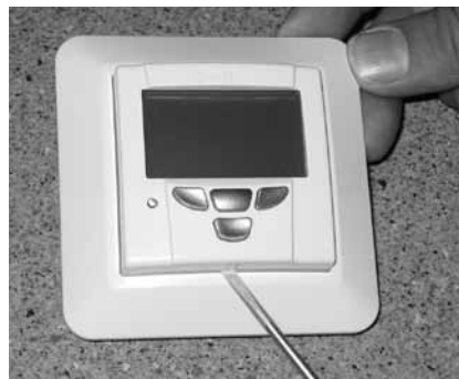
Premium-ohjauspaneelin etupaneelin irrottaminen.
