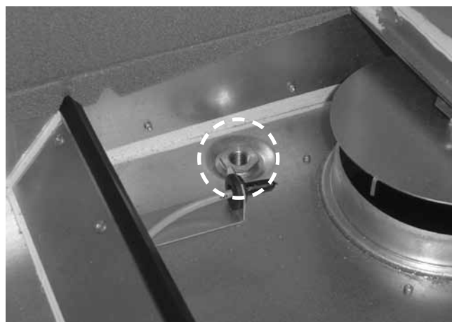
Kondenssivedenpoistoaukko on koneen pohjalla takana.
