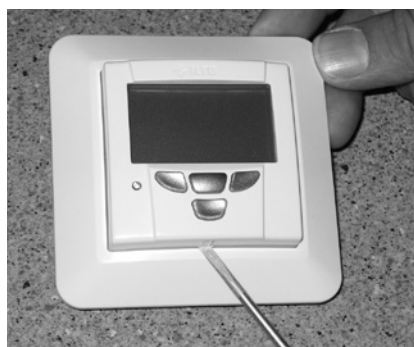
Premium-ohjauspaneelin etupaneelin irrottaminen.
